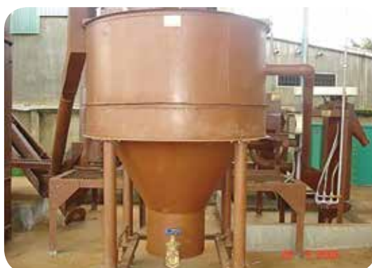
Hình 3. Bể siphon kim loại
