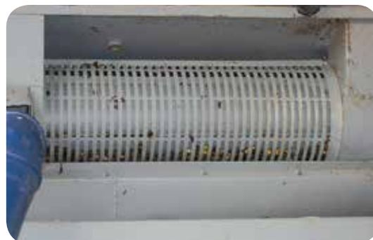
Hình 5. Bộ phận tách quả xanh của máy phân loại quả
