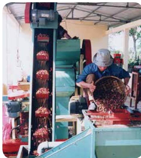
Hình 10. Nạp quả bằng gầu tải (Hình trên mô tả việc nạp quả bằng gầu tải. Một băng tải có gắn các gầu múc, do mô tơ kéo, múc quả từ một cửa của bể siphon để đưa tới máy xát vỏ quả)
