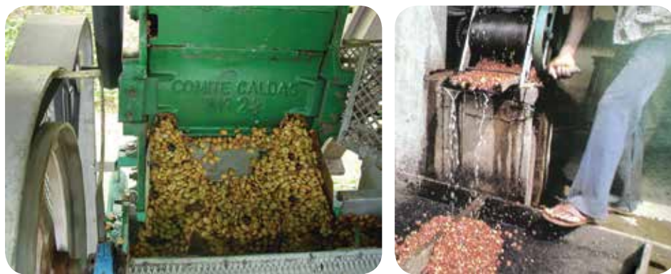
Hình 11. Xát tươi dùng máy xát trống
